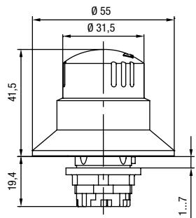
**NHT04D** Not-Halt-Taste mit beleuchtbarem Blockierschutzkragen
