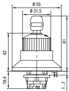
**NHT05D** Not-Halt-Taste mit Betätigungsenschutzkragen
