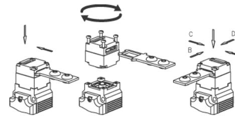
Fig.4 Umstellen der Betätigungsrichtung/
