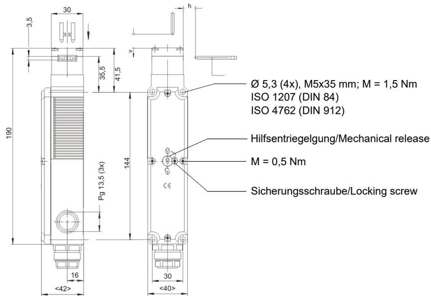
Fig.1 Maßzeichnung/Dimensional drawing
