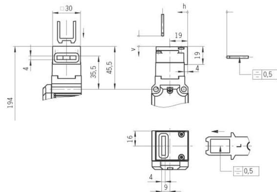
Fig.3 Betätigungskopf mit Einführtrichter/
