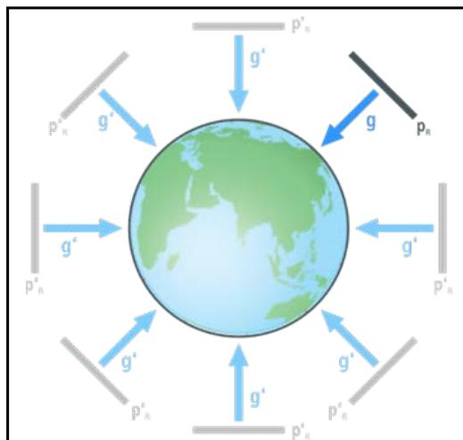
Um Informationen über seine Neigung zur Umgebung zu erhalten, erkennt das System den Erdschwerevektor  $g$  (Abbildung 20). Aus der orthogonal zum Erdschwerevektor stehenden Normreferenzebene und der Ausrichtung des Sensors, berechnet dieser die Neigungswinkel.
