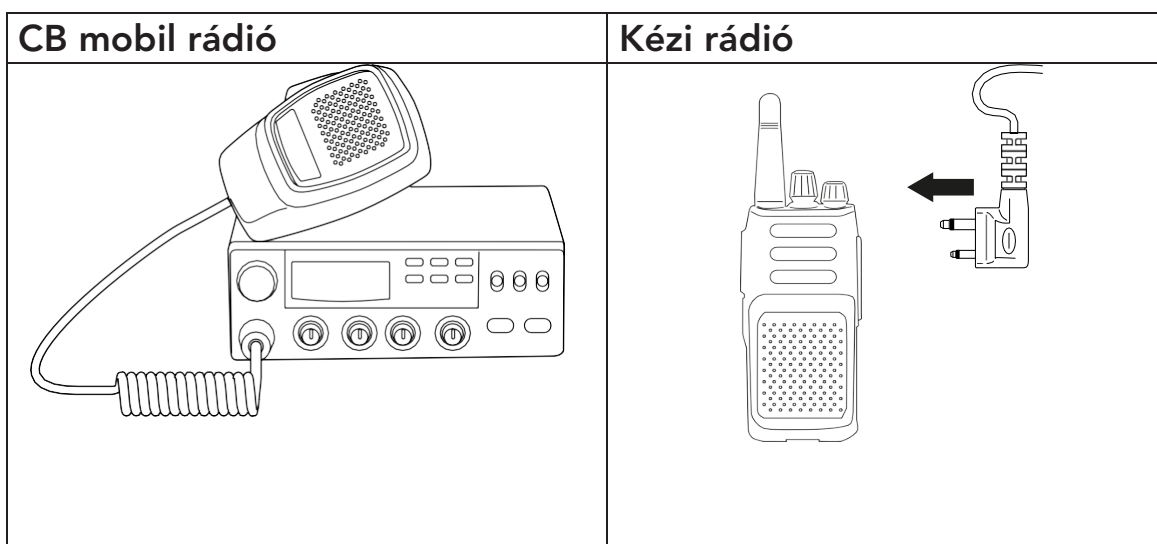
Img. 15 A rádióvezérlő csatlakoztatása a rádiós modulhoz
